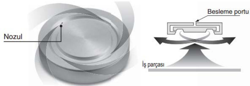
Şekil 9. Siklon tutucunun hava yönü
