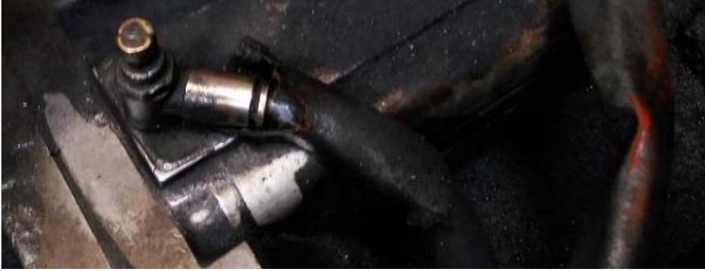
Şekil 9. Kaynak cürufuna karşı alınan verimsiz önlem
