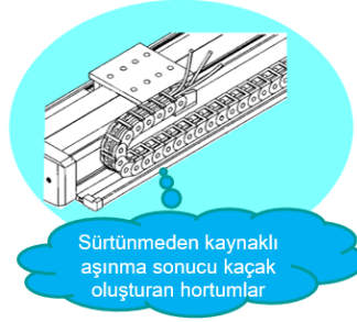
Şekil 6. Kartezyen robot uygulamasında sürtünmeden kaynaklı hava kaçıran poliüretan hortumlar
