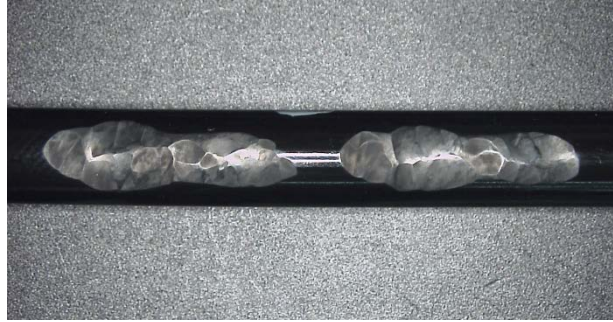
Şekil 7. Yüksek oranda aşınan poliüretan hortum
