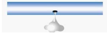
Şekil 5. Hortum üzerinde delik sonucu oluşan kaçak
