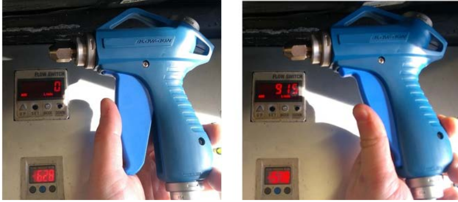
Şekil 21. Dış çapı Ø12 mm'lik hortum yerine Ø6 mm orifis çaplı hava tabancası kullanım önerisi [12]
