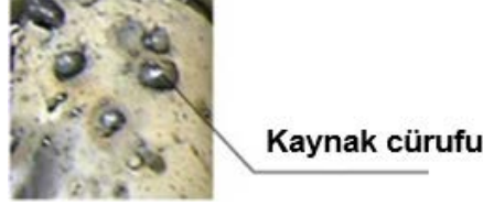
Şekil 11. Kaynak cürufuna karşı önlem alınmamış silindir mili [9]
