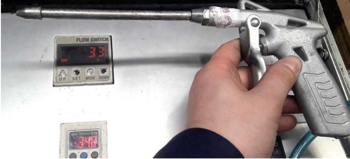
Şekil 23. Parça üzerinde bulunan talaş temizliğinin standart hava tabancasıyla oluşturduğu tüketim
