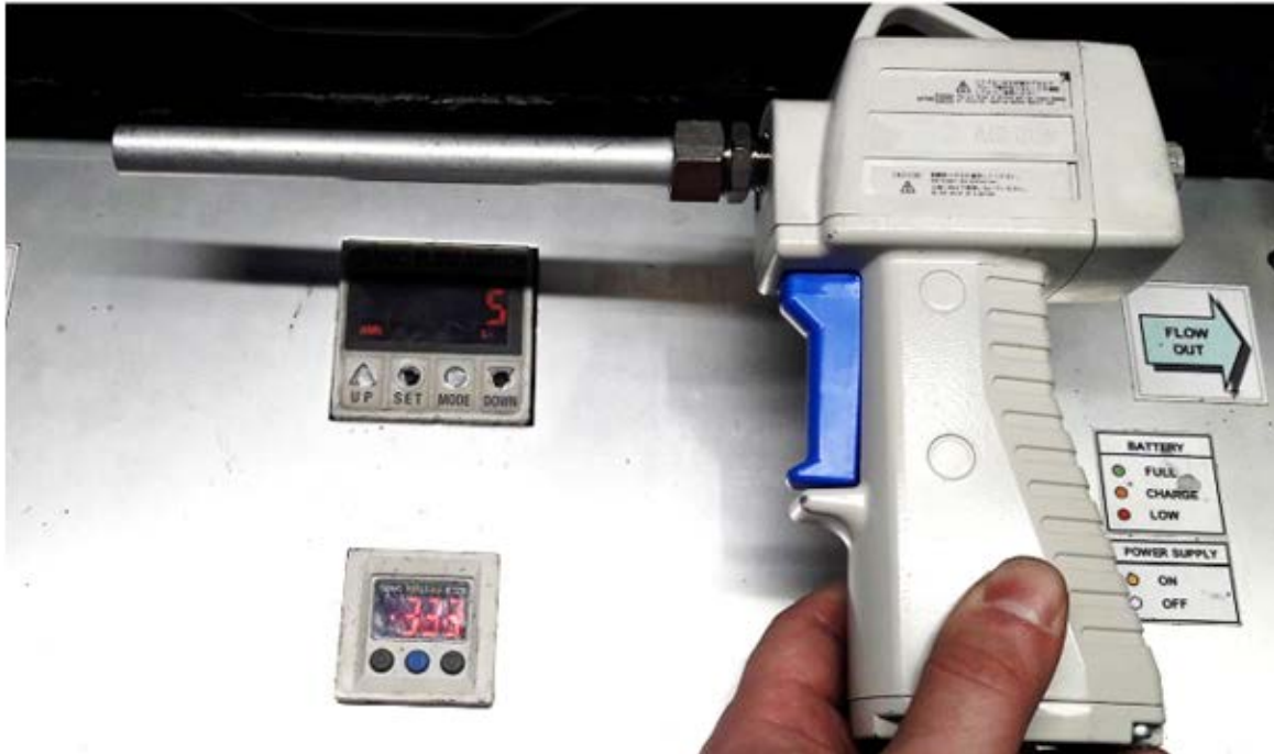
Şekil 24. Talaş temizliğinin darbe üfleme etkili tabancalarla yapılmasıyla oluşan tüketim
