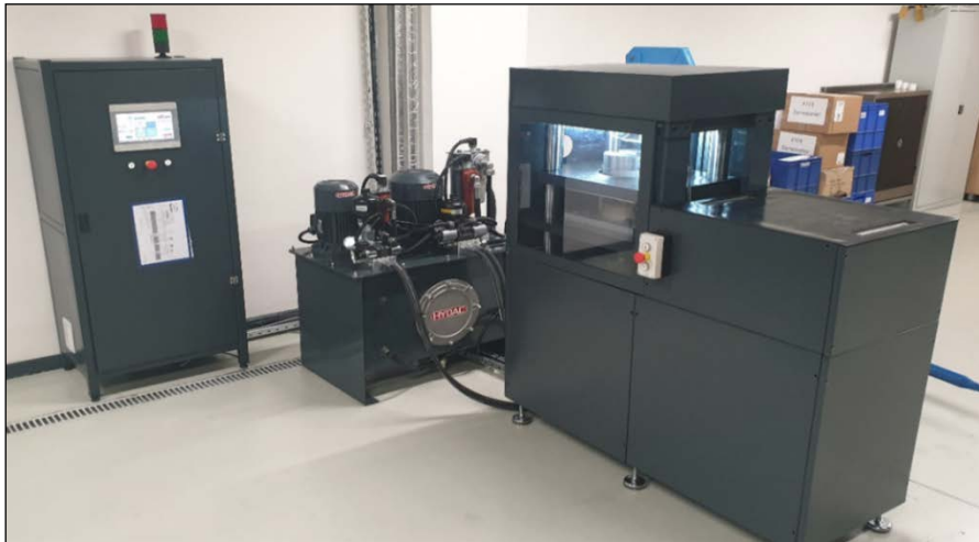
Şekil 8. Yataklama Elemanı Test Cihazı
