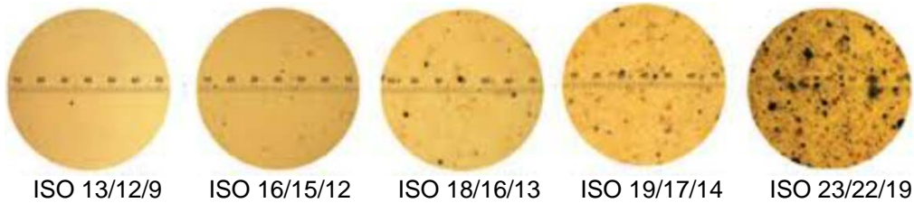
Şekil 3. Farklı ISO 4406 hidrolik sıvı sınıflarının görselleri [10]
