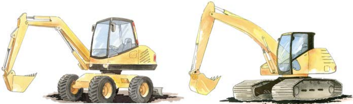
Şekil 3. Ekskavatör tipleri-Lastik Tekerlekli Ekskavatör(Sol el yönü)-Paletli Ekskavatör(Sağ el yönü) [3].
