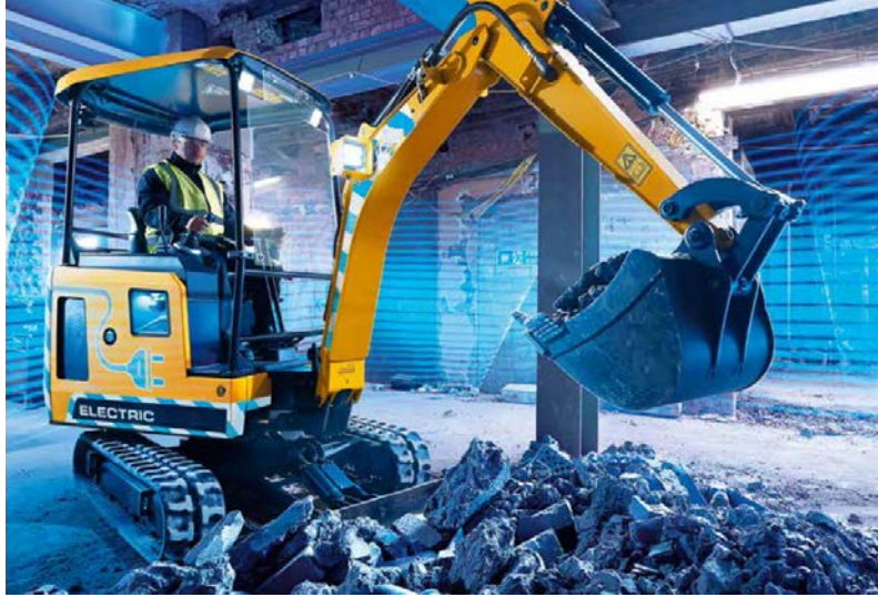
Şekil 1. Şehir içi kullanımı olan elektrikli mini ekskavatör [1].
