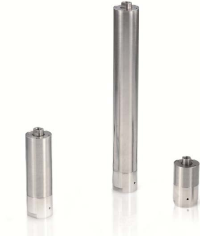
Şekil 3. Bu piezo aktüatörler 180 µm strok ile 4500N itme kuvveti uygulayabiliyorlar ve sadece 191mmX25mm boyutundalar
