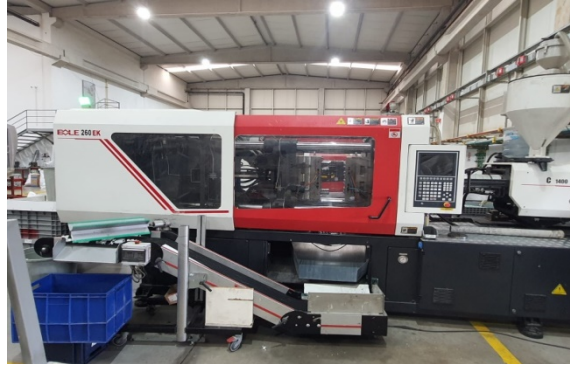
Şekil 4. Prototip numune üretimi sırasında kullanılan plastik enjeksiyon makinesi.
