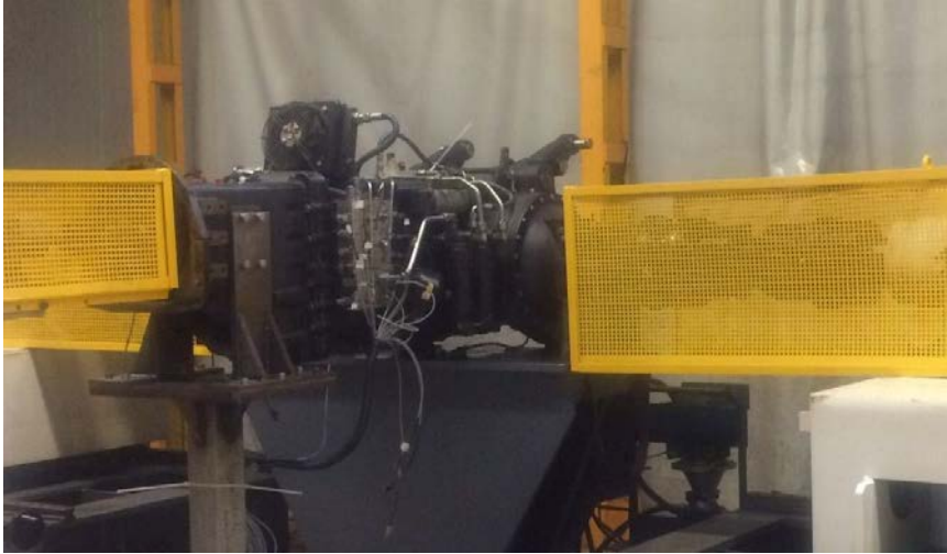
Şekil 15. Valf ve transmisyon kontrol sisteminin testleri
