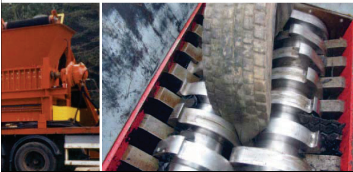
Şekil 17. İki Döner Şaftlı Lastik Parçalayıcı
