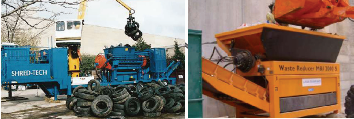
Şekil 19. Araba Lastiği ve Ev Çöpü İçin İkincil Parçalayıcı
