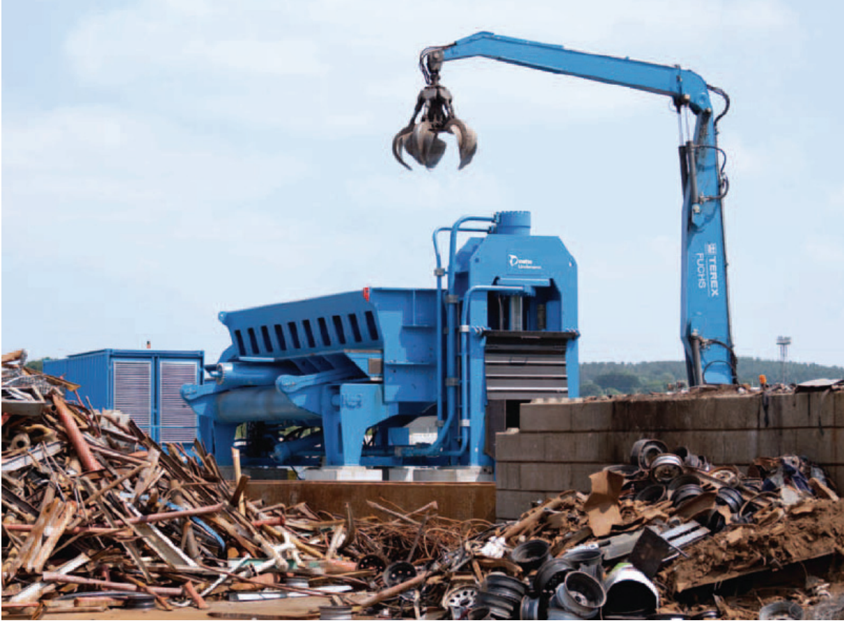
Şekil 3. Güç Ünitesi de İhtiva Eden Bir Hurda Pres ve Kesme Kombine Makinesi
