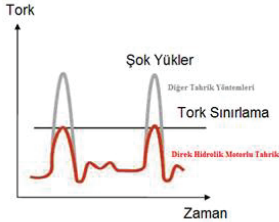
Şekil 24. Tahrik Sistemlerinin Şok Yüklere Tepkisi
