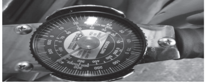
Şekil 9. Pelflexli bağlantı elemanı ve sıkılan Tork değeri
