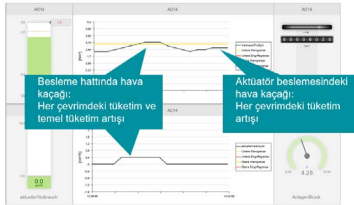
Şekil 4. Hava Kaçağı Denetleme Penceresi
