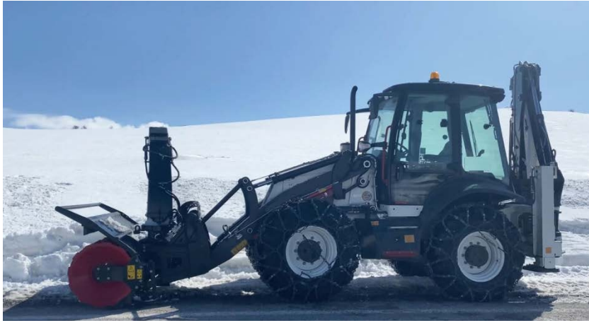
Şekil 22. Kar rotatifi ataşmanı saha denemesi.
