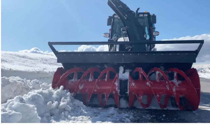
Şekil 21. Kar rotatifi ataşmanı saha denemesi.
