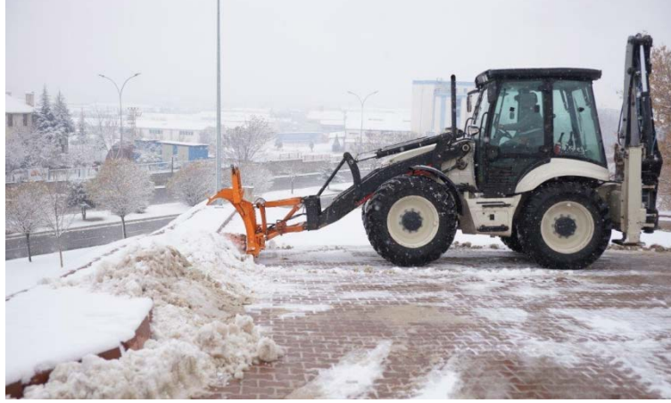
Şekil 2. Kazıcı ve yükleyici iş makinelerinde kar küreme ataşmanı kullanımı.
