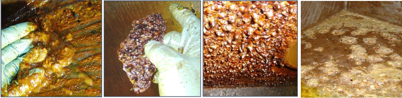
Çamur şeklinde vernik Sert ve kırılğan vernik Tank tavanında vernik. Tank tabanında vernik [15] Vernik tortu örnekleri
