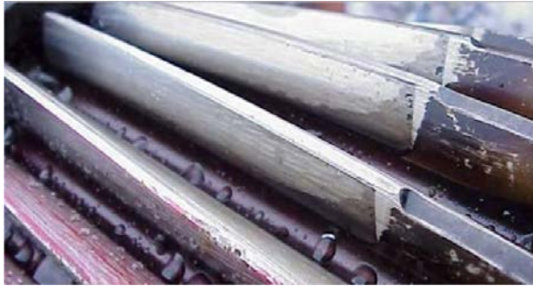
Başlangıç seviyesi micro-pitting
