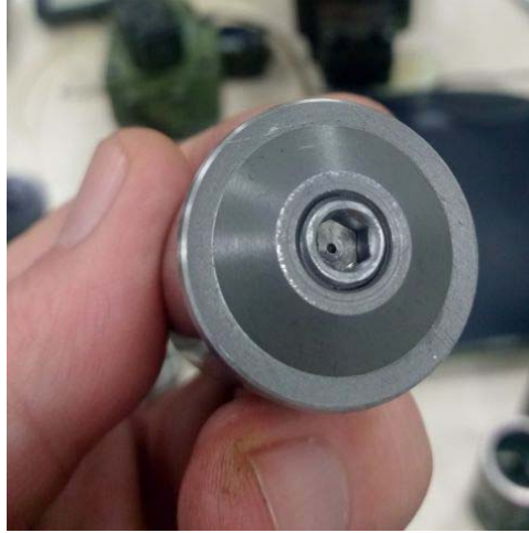
Şekil 13. Pilot deliği, kapama elemanının alın tarafında
