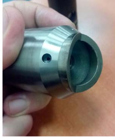
Şekil 15. Pilot deliği, kapama elemanının konik kısmında.
