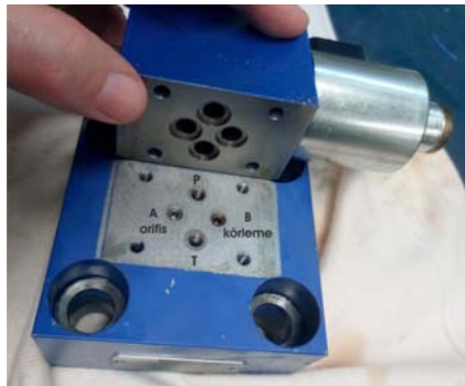
Şekil 32. Hidrolik blok ve lojik valf kapağı
