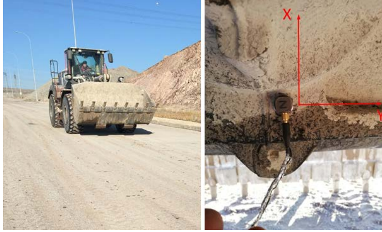
Şekil 7. Makine üzerindeki ivme ölçerin konumu
