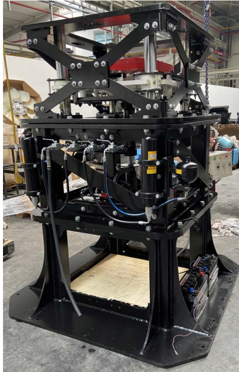
Şekil 6. Montajlanmış HPS sistemi
