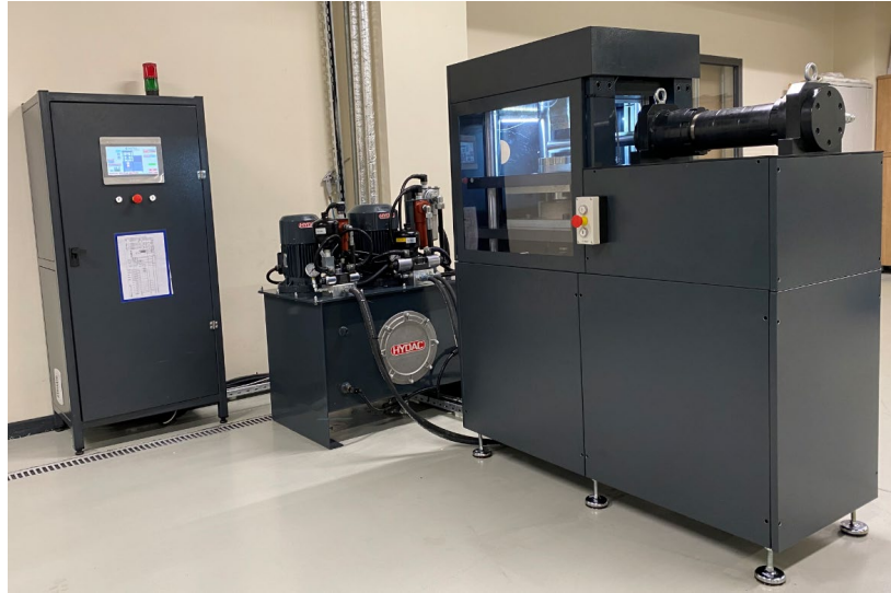
Şekil 4: Yataklama Test Cihazı
