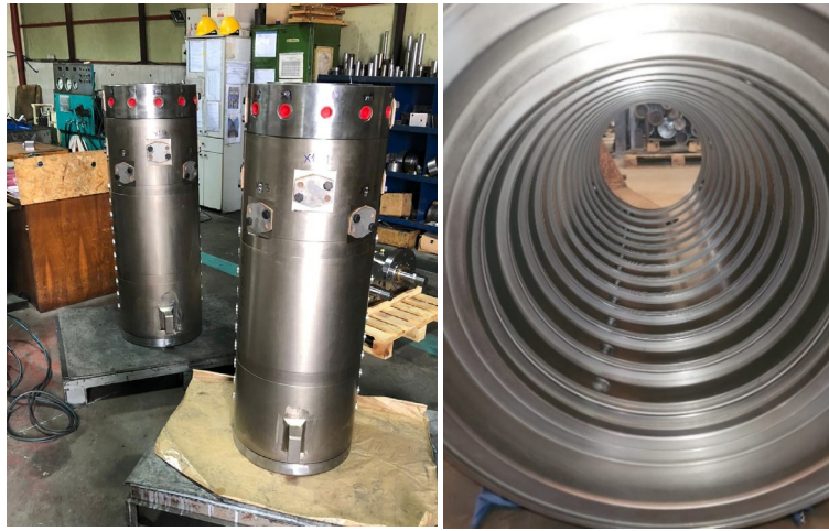
Şekil 2. Nikel bor kaplama uygulanan karmaşık geometrili dağıtıcı parçalar
