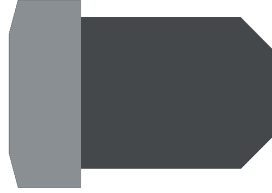
Şekil 10. Piston Sızdırmazlık Elemanı-5 Kesiti
