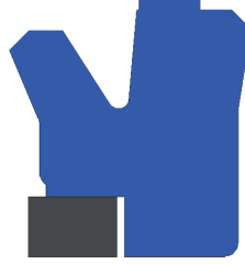
Şekil 14. Piston Sızdırmazlık Elemanı-11 Kesiti
