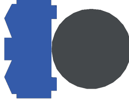
Şekil 9. Piston Sızdırmazlık Elemanı-4 Kesiti
