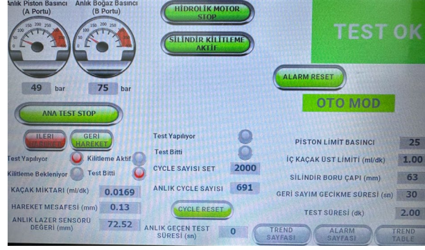
Şekil 5. Piston İç Kaçak Test Düzeneği Ekranı
