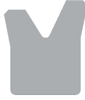
Şekil 14. Piston Sızdırmazlık Elemanı-10 Kesiti
