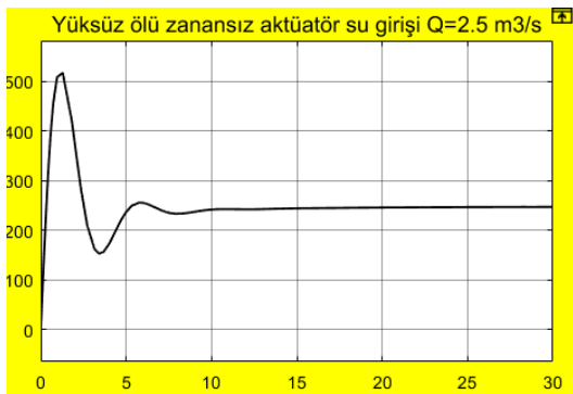
Şekil 7. Rölanti çalışma durumu (yük M=275 Kpm, Tahrik momenti M=1360 Kpm)
