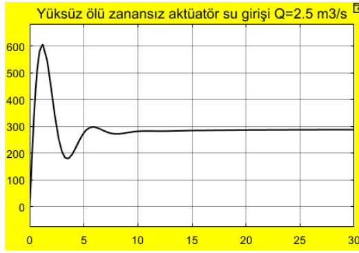
Şekil 8. %10 yükte çalışma durumu (yük M=300 Kpm, Tahrik Momenti M= 1587 Kpm)
