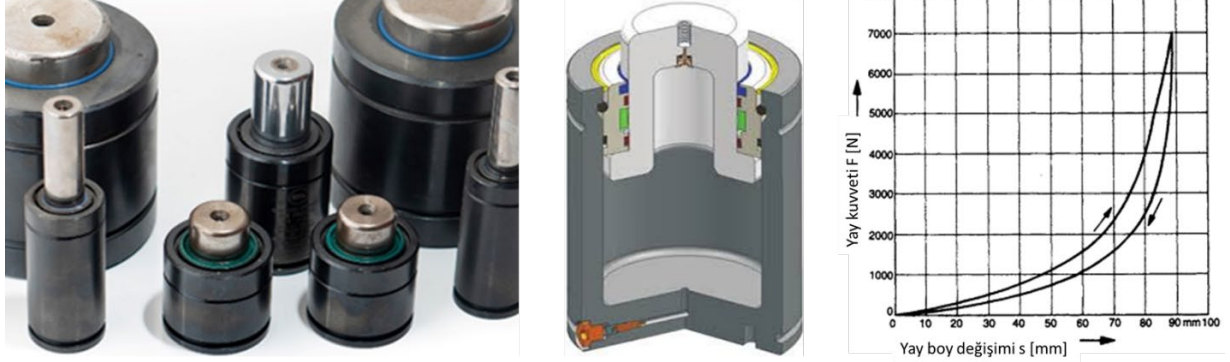
Őekil 3: kalıpcılıkta mekanik yayların yerine kullanılan gazlı (pnömatrik) yayalar ve yay karakteristiđi (ScienceDirect).
